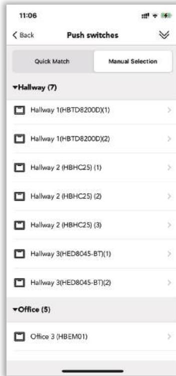
Schritt 2. Stellen Sie in einer der 4 Geräte Push-Schaltereinstellungen das Steuerobjekt auf die gesamte Zone ein. Stellen Sie die Funktion "Doppeldruck" ein, um die Szene auszulösen.
