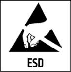
Das Leuchtmittel darf nur vom Hersteller oder einer Person, die vom Hersteller dazu autorisiert wurde, gewechselt werden. Das Produkt enthält elektronische Bauteile, die im Hinblick auf elektrostatische Entladung (ESD) und mechanische Belastung empfindlich sind. Um Schäden an den LED-Chips zu vermeiden, berühren Sie Leiterplatten ohne Abdeckung, wie zum Beispiel ein LED-Modul, weder mit der Hand noch mit einem Werkzeug. Dies muss bei der Wartung beachtet werden.
