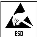
Valonlähteen saa vaihtaa ainoastaan valmistaja tai valmistajan valtuuttama henkilö. Tuote sisältää sähköstaattisille purkauksille (ESD) ja mekaaniselle rasitukselle herkkää elektroniikkaa. Vahinkojen välttämiseksi, vältä koskemasta avointa piirilevyä, kuten esim. LED-moduulia käsin tai työkalulla. Tämä tulee huomioida huollon aikana.
