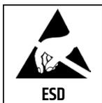
Ljuskällan får endast bytas ut av tillverkaren eller en av tillverkaren auktoriserad person. Produkten innehåller elektronik som är känslig för elektrostatiska urladdningar (ESD) och mekanisk påfrestning. För att inte skada LED-chipsen bör direkt kontakt med ett kretskort, t.ex. LED-modulen, med hand eller verktyg undvikas. Tänk på detta vid underhåll.
